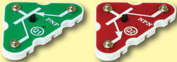
PNP & NPN Transistors (Q1 & Q2)
